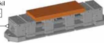
Gezer paraleller üzerinde ince iş parçası bağlama şekli Figure clamping thin workpiece on motion parallels
